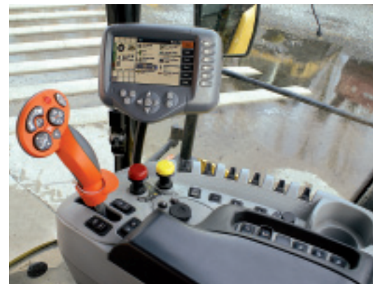
Ein neuer stufenloser Fahrhebel und der bekannte ISOBUS-Terminal sind zentrale Bedienelemente des neuen FR.
